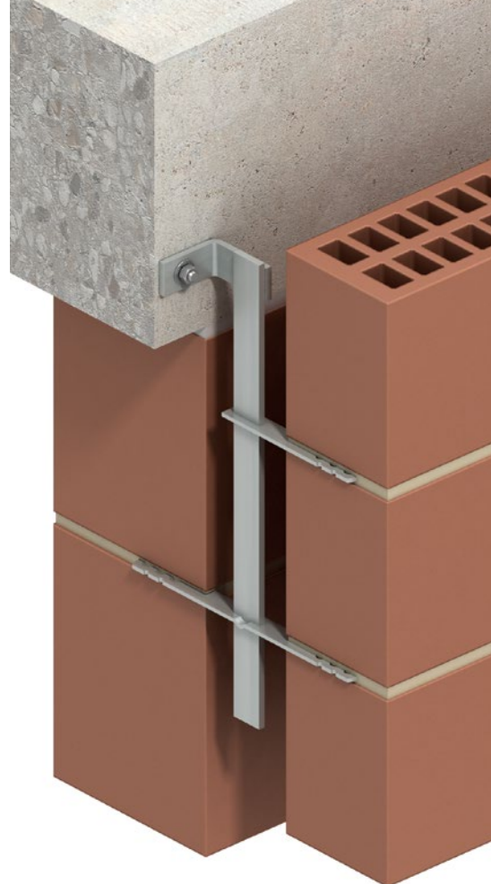
Retenue de tête Ancon FHR fixée sur le côté inférieur de la dalle de sol, retenant la tête de la face intérieure du mur creux
